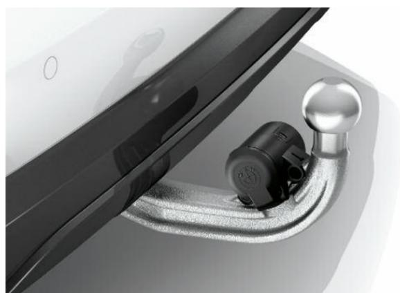
Le dispositif d'attelage avec rotule escamotable électriquement est homologué pour un poids remorquable élevé (jusqu'à 2 400 kg). Le système de stabilisation de l'attelage freine automatiquement le véhicule en cas de mouvement de roulis de la remorque. Non utilisé, le crochet s'escamote électriquement à l'abri des regards, sous la jupe arrière.
