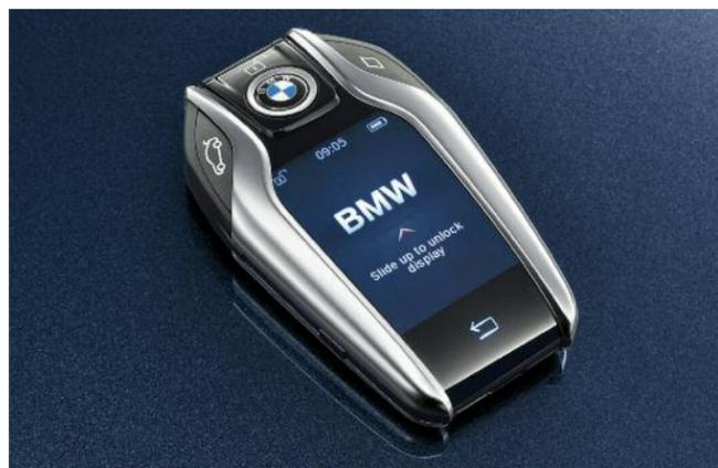
La clé intelligente « BMW Display Key » indique différents statuts de la voiture et permet de commander certaines fonctions grâce à son écran tactile. Il est ainsi possible d'activer par exemple le chauffage auxiliaire (en option) avec la clé.
